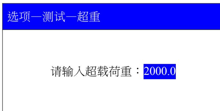
该界面用以设置荷重上限值，依荷重元所能承受的最大力值，输入该值，单位为 KGF。如外界所受力超过该值，机器停机并报警。
